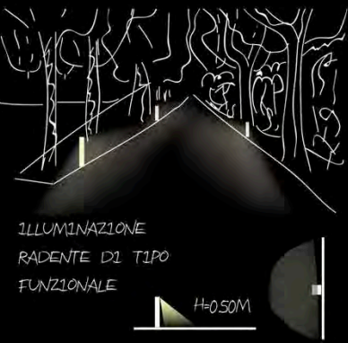
ILLUMINAZIONE VERSO IL BASSO APPARECCHI PUNTUALI CON UN OTTICA ASIMMETRICA. ILLUMINAZIONE SOLO DEI PERCORSI, CON PALETTI BASSI PER NON ESPORRE LA VEGETAZIONE A LUNGI TEMPI DI ESPOSIZIONE ALLA LUCE ARTIFICIALE.
