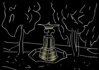
ILLUMINAZIONE A PROIEZIONE APPARECCHI AD INCASSO A PAVIMENTO CON OTTICHE ORIENTABILI DAL BASSO VERSO L'ALTO E OTTICHE STRETTE CON LENTE ELLITTICA PROIEZIONE MIRATA PER EVITARE ABBAGLIAMENTO.
